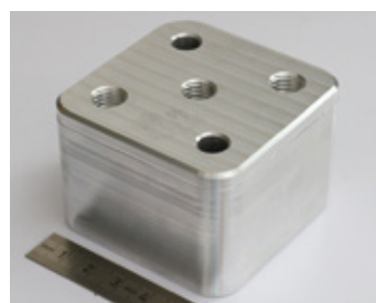
Abb. 8: Das geschweißte Bauteil nach dem groben Zerspanen.
